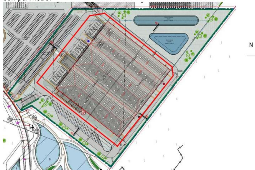
Le plan masse général permet de constater que la voie de circulation des engins de secours présente une largeur minimale de 6 mètres.
